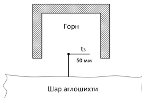
Рисунок 2.37 – Точка контролю температури запалювання аглошихти
