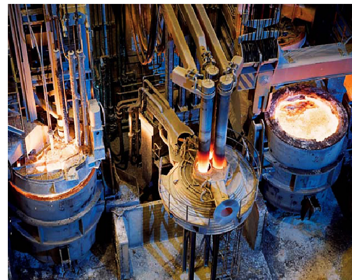
Рисунок 4.28 – Загальний вигляд установки (з одного ківша знята кришка, а на другому йде підігрів металу)
