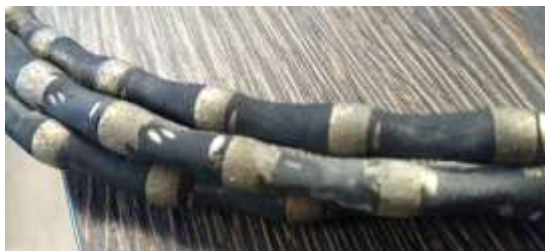
Рис. 5. Конусна форма перлин, викликана використанням значної швидкості розкриття алмазного шару
