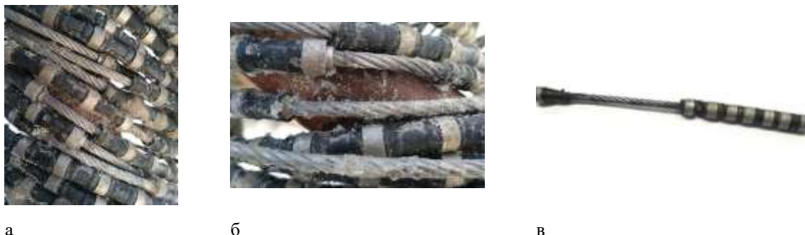
Рис. 2. Приклади перегріву канату
