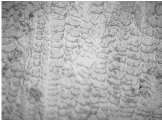
Рис. 2. Мікроструктура наплавленого металу (x400) – дрібнозернистий аустеніт
