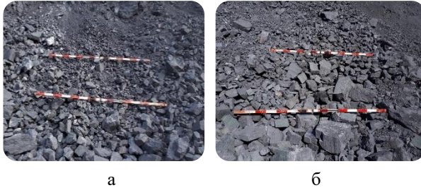
Рис. 1. Фото-планограми ділянок рудних масивів, підірваних за стандартною (а) та експериментальною (б) методикою
