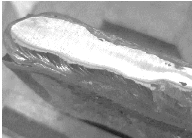
Рис. 1. Макрошліф для виявлення гарячих тріщин (ММА, \phi=5\text{мм} , I_{зв}=175\text{А} , V_{охол}=80\dots100\text{ град/хв} )
