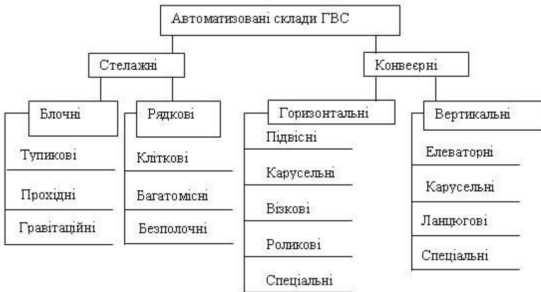
Рисунок 4.1 - Класифікація МСК за способом складування об'єктів і технічним оснащенням
