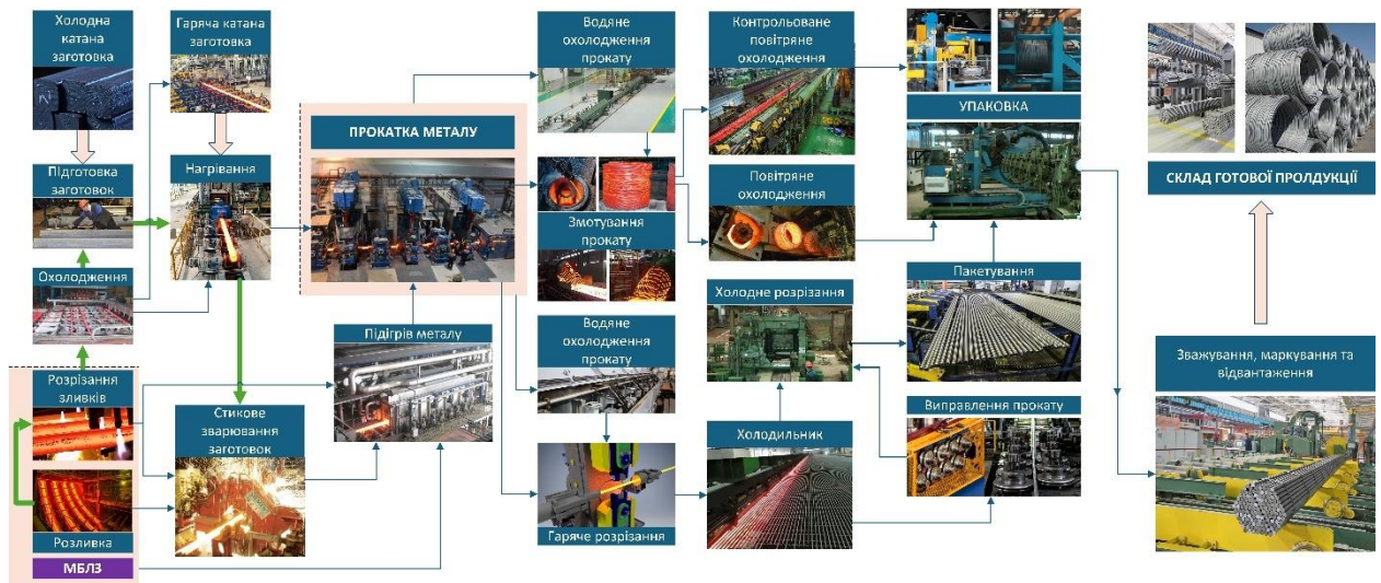
Рисунок 7.2 – Багатоваріантна потокова схема основних технологічних операцій під час виробництва сортового прокату
