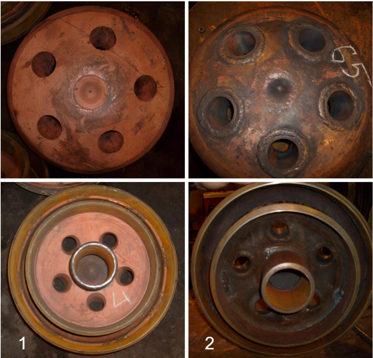
Рисунок 1.2 – Литий або пресований (1) і зварений (2) кінцевики кисневої фурми
