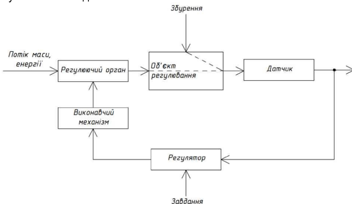
Рисунок 1.11 - Система регулювання одноконтурна
