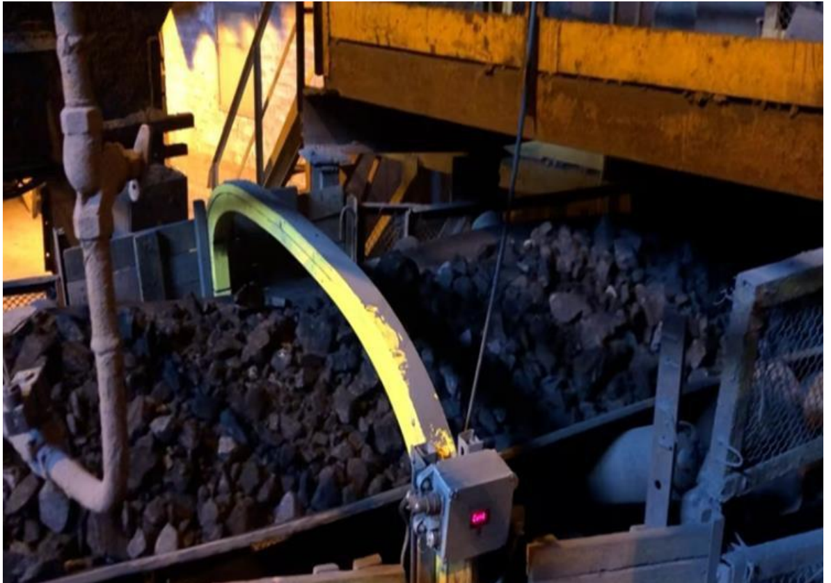
Рисунок 2.3 Металодетектор встановлений на стрічковому конвеєрі.
