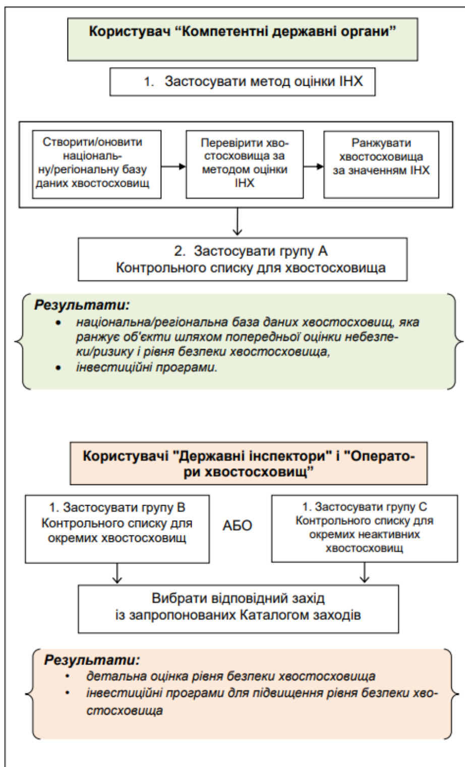
Рисунок 4.5 – Порядок застосування Контрольного списку для хвостосховищ [10]
