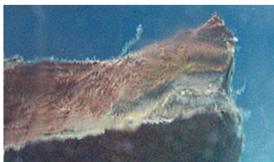
Рисунок 3.6 – Ниткоподібні утворення гелю кремнієвої кислоти \text{SiO}_2 під час розчинення залізистих кварцитів [34]
