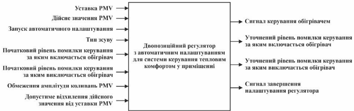
Рис. 2. Вхідні та вихідні параметри двопозиційного регулятора з автоматичним налаштуванням для системи керування тепловим комфортом у приміщенні
