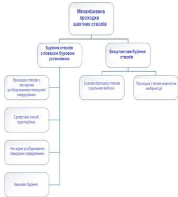
Рис. 8. Класифікація способів механізованої проходки шахтних стволів та свердловин
