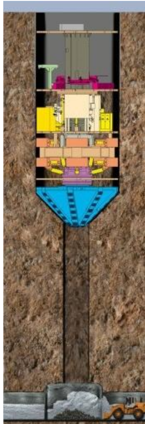
Рис. 21. Проходка ствола за технологією V-Mole з передовою свердловиною
