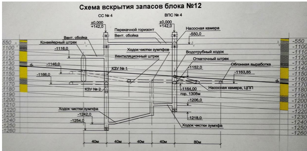
Рис. 1. Схема розкриття блоку №12 ШУ «Покровське»
