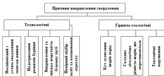
Рис. 10. Причини викривлення стволів та свердловин
