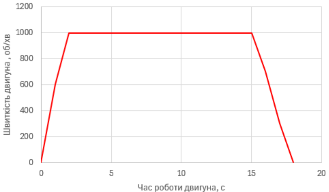
Рисунок 3.6 - Діаграма роботи двигуна при прямому пуску
