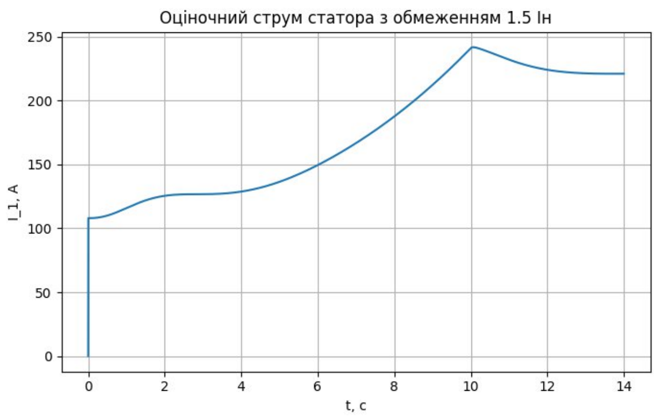
Рисунок 2.25 – Струм статора з системою кервання та задавачем інтенсивності
