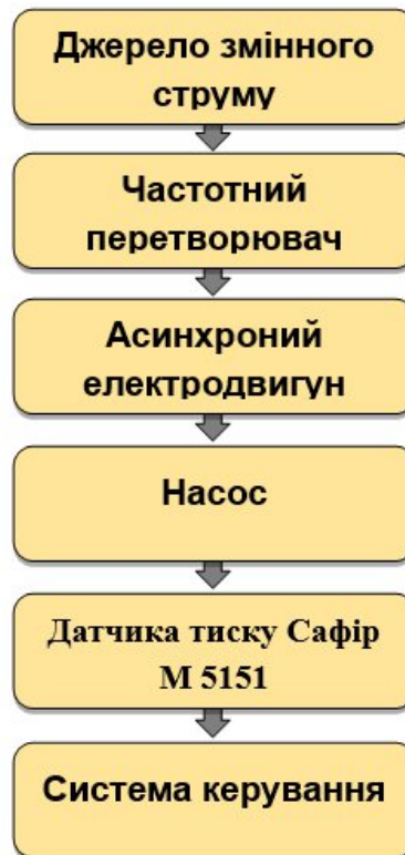
Рисунок 2.14 – Схема системи з використанням частотного перетворювача та датчика тиску Сафір М 5151
