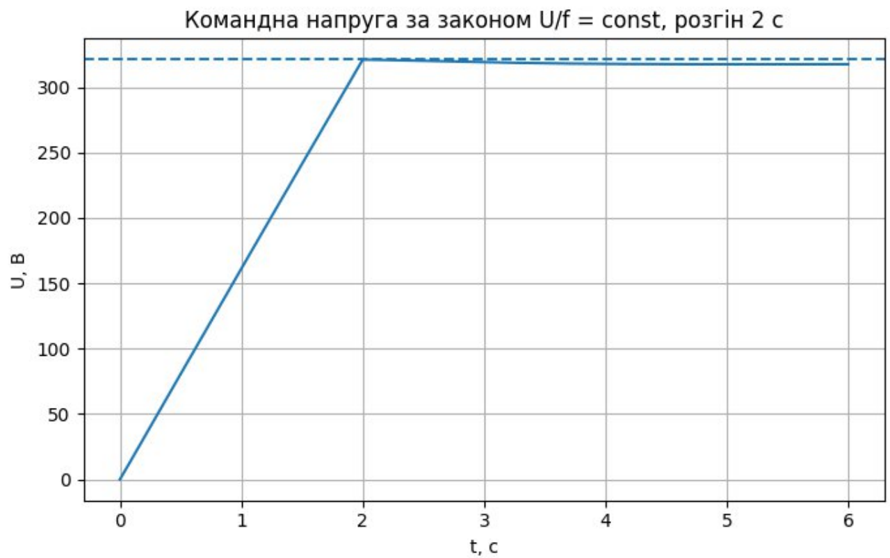
Рисунок 2.38 – Завдання та закон зміни напруги завдання при завданні тиску 5 \text{ кг/см}^2 та зменшення часу розгону на задаваче інтенсивності до 2 с.
