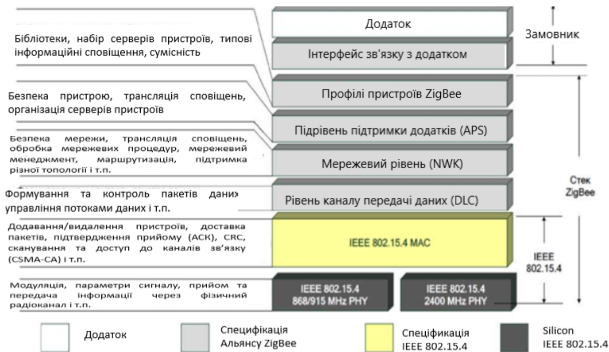
Рисунок 7.3 – Конфігурація стеків протоколу IEEE Std 802.15.4 та ZigBee
