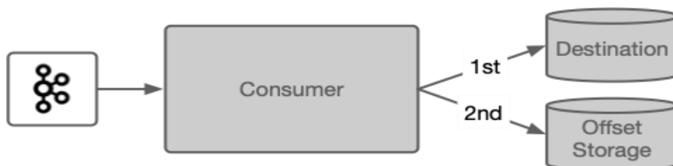
Рис. 5. Дуплікація даних при відмові сервера під час обробки повідомлення
