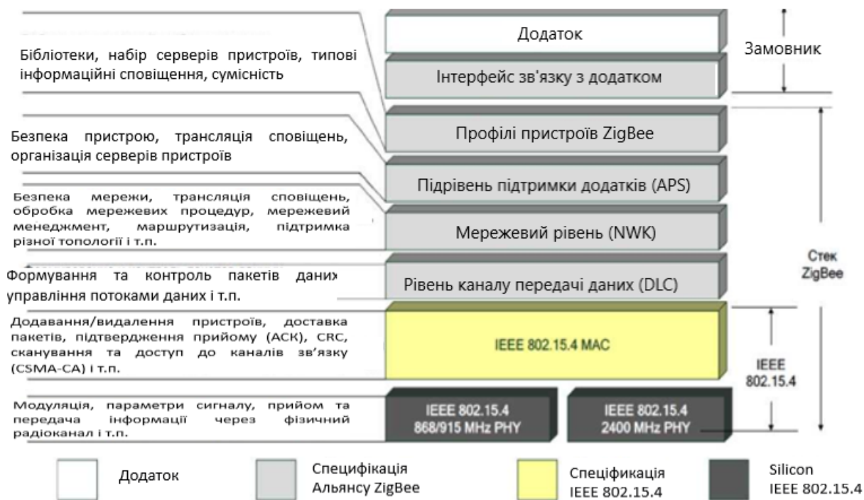
Рисунок 7.3 – Конфігурація стеків протоколу IEEE Std 802.15.4 та ZigBee
