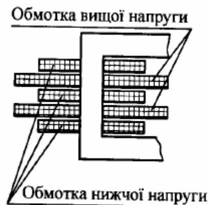
Рисунок 4.11 - Стрижень та ярма трансформатора з переміжними обмотками
