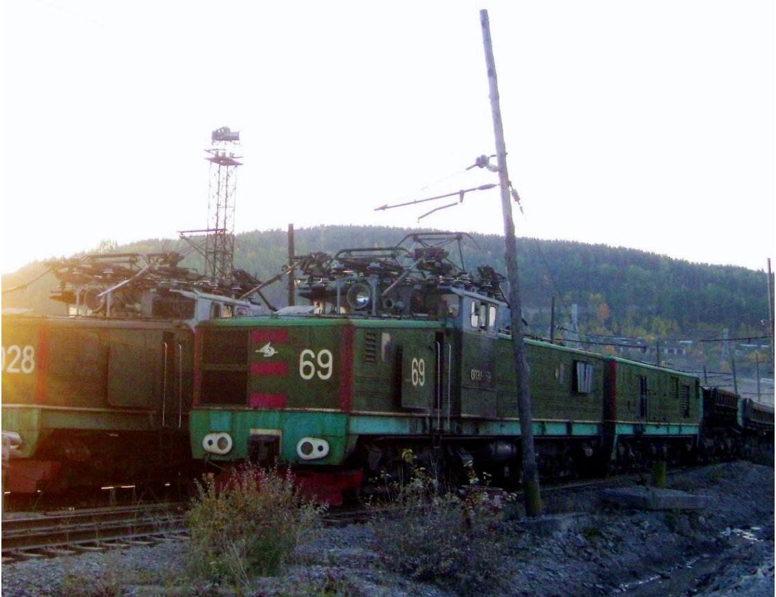
Рис. 2.3 – Загальний вид тягового агрегату ОПЕ1АМ
