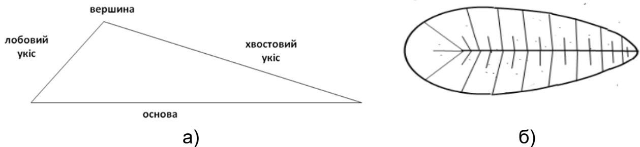
Рисунок 7.1 – Конічний відвал: а) профіль; б) план
