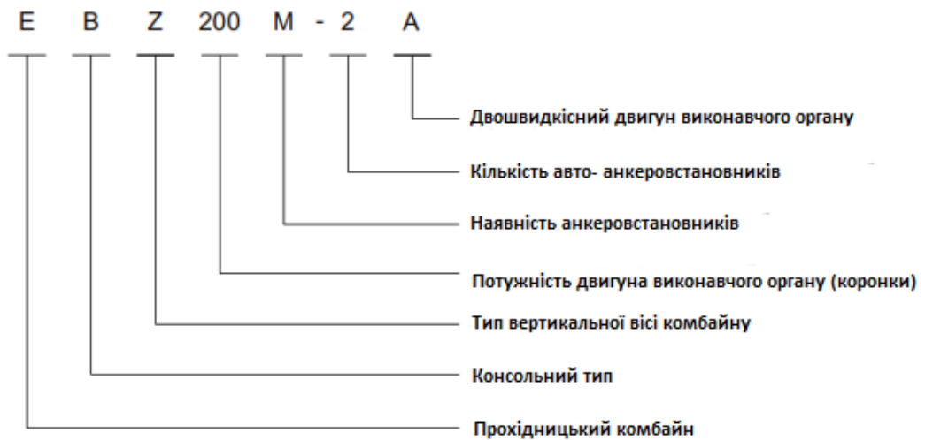
Рисунок 3.3. Розшифровка позначення марки комбайна EBZ200M-2A
