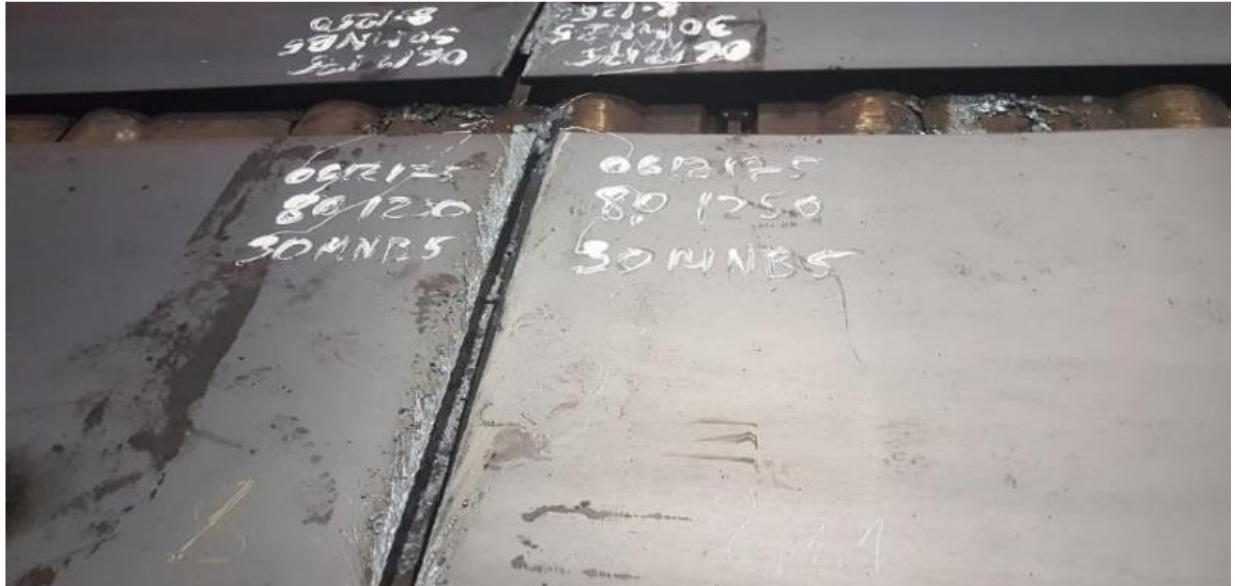
Рис. 3.6 – Приклад маркування порізаних листів зі сталі 30MnB5
