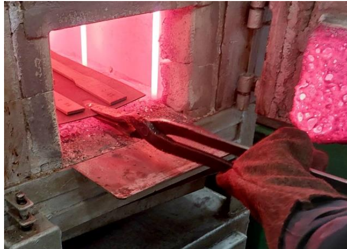
Рис. 2.4 – Завантаження зразків у піч при проведенні термічної обробки
