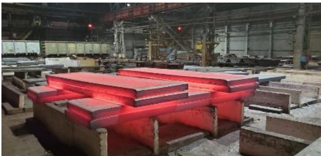
Рис. 3.2 – Загальний вигляд укладених слябів
