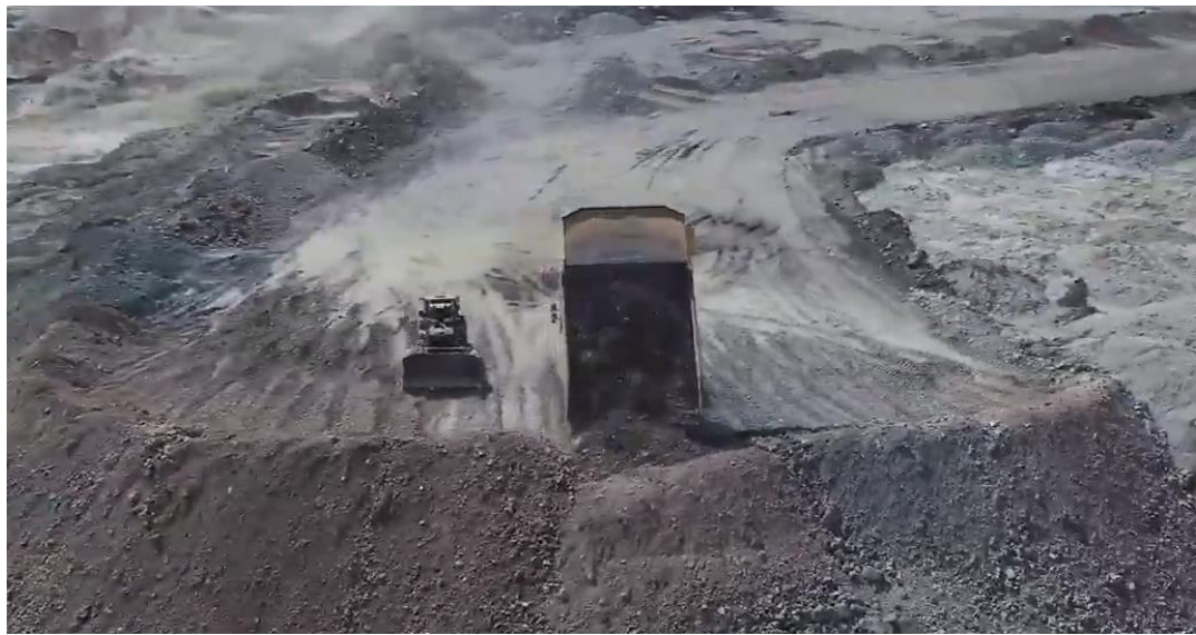
Рис. 8.1 - Бульдозерне відвалоутворення при доставці гірничої маси автосамоскидами
