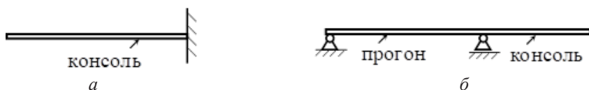
Рисунок 1.10 – Види статично визначульних балок
