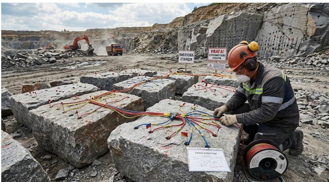
Рисунок 8.6 – Процес комутації (з'єднання) зарядів для вторинного підривання негабариту в умовах гранітного кар'єру.
