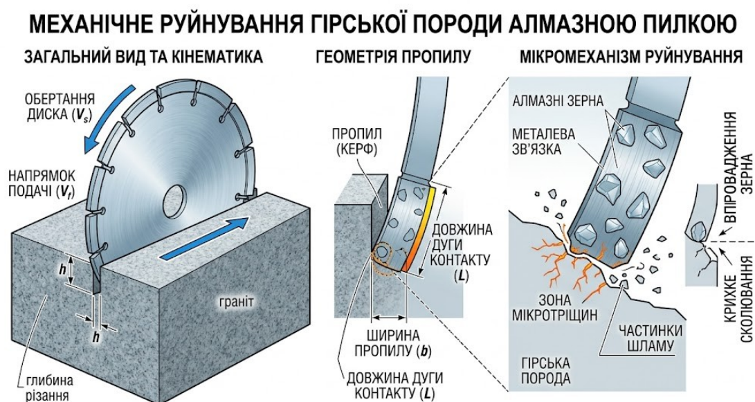
Рисунок 8.2 – Механічне руйнування гірської породи дисковою алмазною пилкою.
