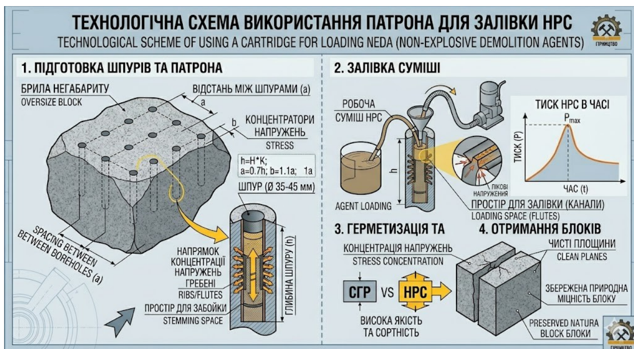
Рисунок 8.9 – Технологічна схема використання патрона для заливки НРС.
