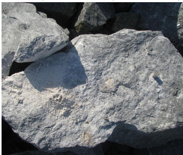
Рисунок 6.3 – Загальний вигляд зруйнованого негабариту з відстанню між шпурами 0,4 м.
