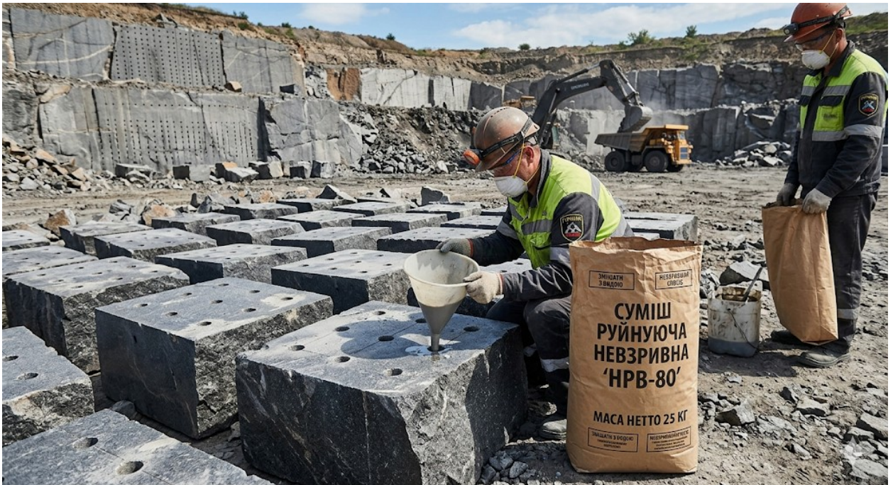
Рисунок 8.8 – Процес заповнення шпурів невзривчастою руйнуючою сумішшю типу НРВ-80 у гранітному кар'єрі.
