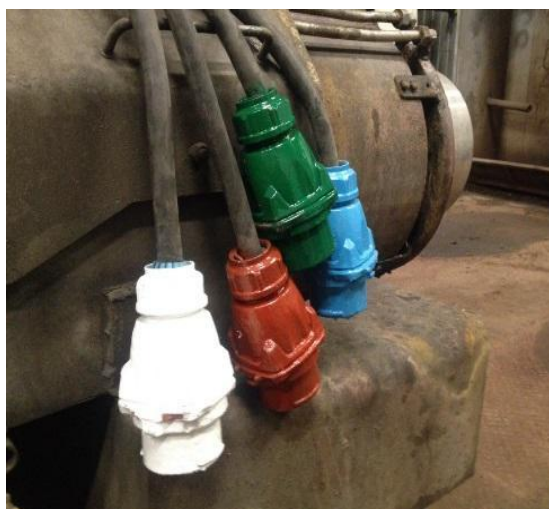
Рисунок 8.10 – Кольорове маркування роз'ємів центрифуги
