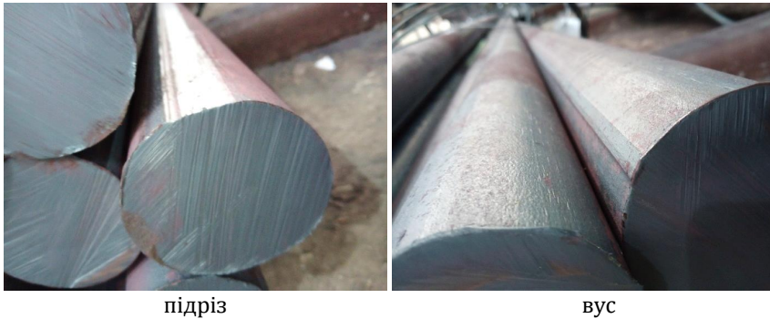
Рис. 1. Дефекти на передніх та задніх кінцях малих круглих профілів ТЗС
