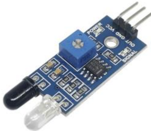
Рисунок 3.2 – IR оптичний датчик перешкод.
