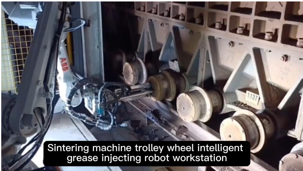
Рисунок 1.12 – Впорскування мастила у підшипникові вузли спікальних візків.
