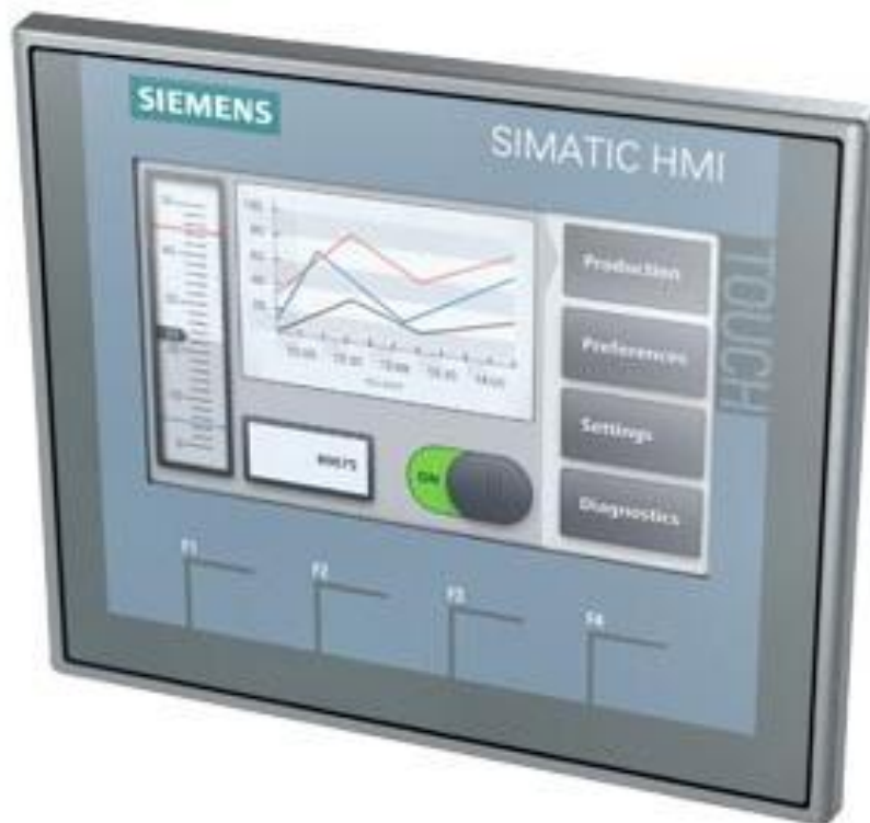
Рисунок 2.6 – Панель керування Siemens KTP400 Basic
