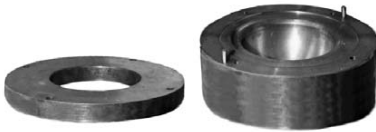
Рисунок 5.1 – Матриця для штампування напівсфер
