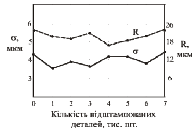
Рисунок 3.10 – Діаграми зміни параметрів \bar{\sigma} і \bar{R} для операції вирубання: а – S = 1,0 мм, D = 90_{-0,1} мм; б – S = 2,0 мм, D = 90_{-0,1} мм; в – S = 3,0 мм, D = 90_{-0,1} мм
