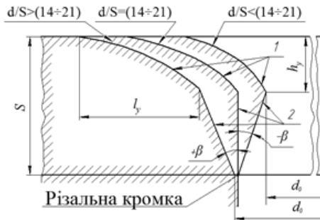
Рисунок 3.16 – Форма поверхні поділу в деталі при пробиванні ПУШ отворів залежно від відносного діаметра:
