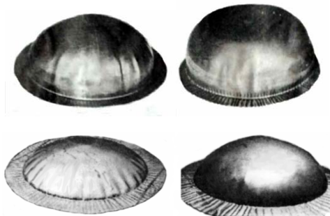
Рисунок 4.1– Характерний брак виробів при високошвидкісному витягуванні тонколистових деталей (хлопуни, гофри на фланці і нерівномірне утягування матеріалу)
