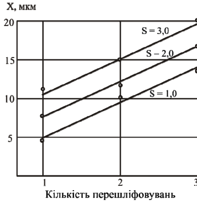
Рисунок 3.12 – Змінення положення центру групування \bar{X} залежно від кількості перешліфовувань і товщини матеріалу
