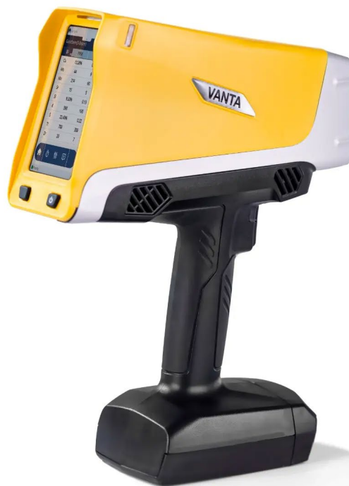
Рисунок 3.1 – Портативний РФА-аналізатор Olympus Vanta для забійного опробування
