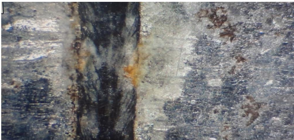
Рисунок 3.2 – Стан поверхні основного покриття ( \times 50 ) після витримки протягом 72 годин в розчині 5-90 %NaCl
