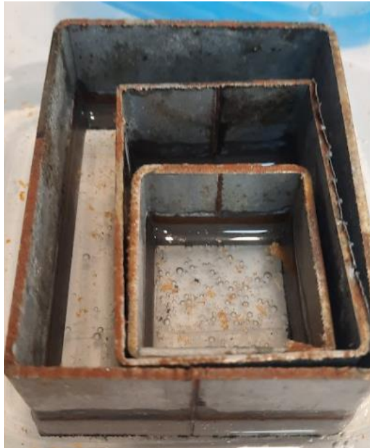
Рисунок 2.3 – Зразки в ванні з 10% розчином HCl (соляної кислоти)
