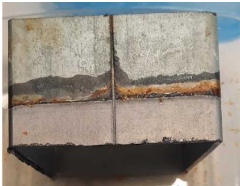
Рисунок 2.4 – Вигляд зразка після витримки в 10% розчині HCl
