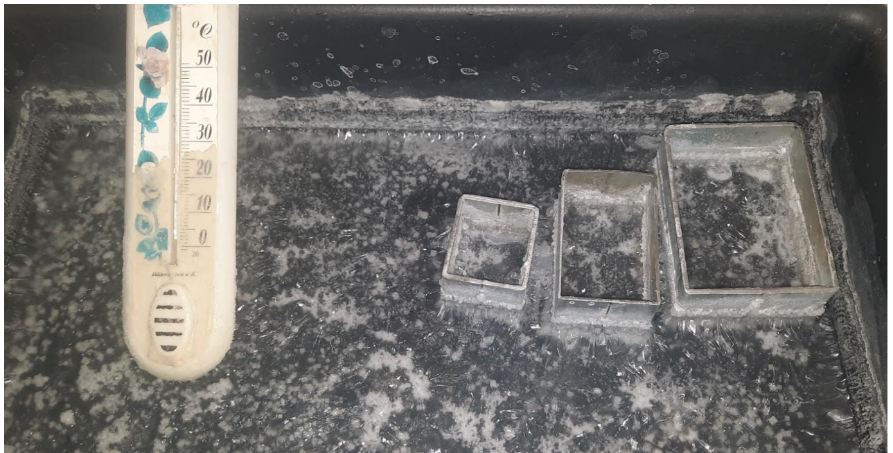
Рисунок 2.2 – Ванна зі зразками (розчин 90% NaCl)
