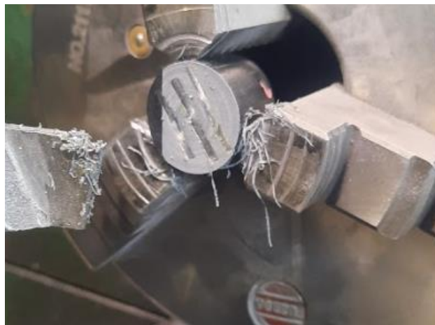
Рисунок 2.6 – Торцювання металографічного зразка на токарному верстаті
