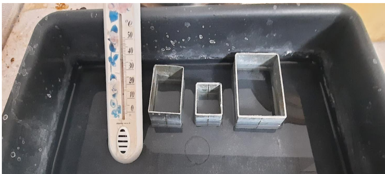
Рисунок 2.1 – Ванна зі зразками (розчин 5% NaCl)
