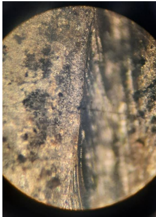
Рисунок 3.5 – Вигляд шва і зони термічного впливу після випробувань (×100)
