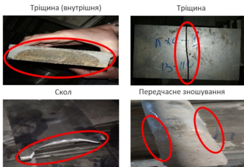
Рисунок 2.5 - Види дефектів пресового оснащення
