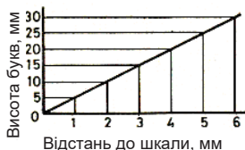
Рисунок 1.31 – Різні типи і форми шрифту (розміри в мм): 1 – найбільш доцільне відношення між висотою букви ( h ), її шириною ( b ) та товщиною ( t ) (для більшості букв b = 3/5h , t = 1/6h - 1/8h ); 2 – залежність висоти букв від відстані до шкали [22]
