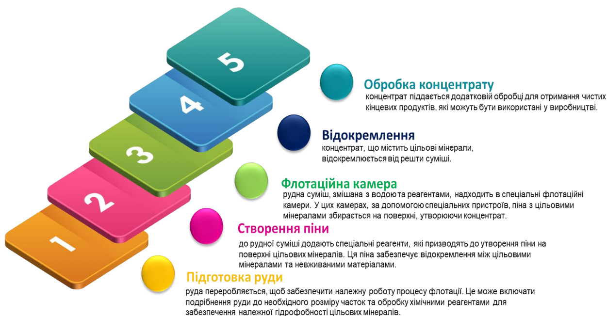
Рисунок 2.6 – Етапи бізнес-процесів МФДК рудо-збагачувальної фабрики №2 ПРАТ «ІНГЗК» (побудовано автором на підставі проведеного аналізу та вивчення внутрішньої документації [53])
