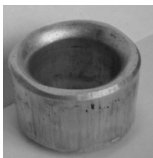
Рис. 5.31. Способ снижения неравномерности деформации и выравнивания торцов втулки, полученной сквозной прошивкой
