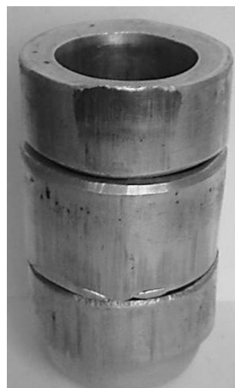
Рис. 5.33 Комплект втулок после сквозной прошивки
