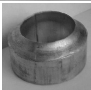
Рис. 5.32. Дефект типа утяжины, полученный на торцах втулки
