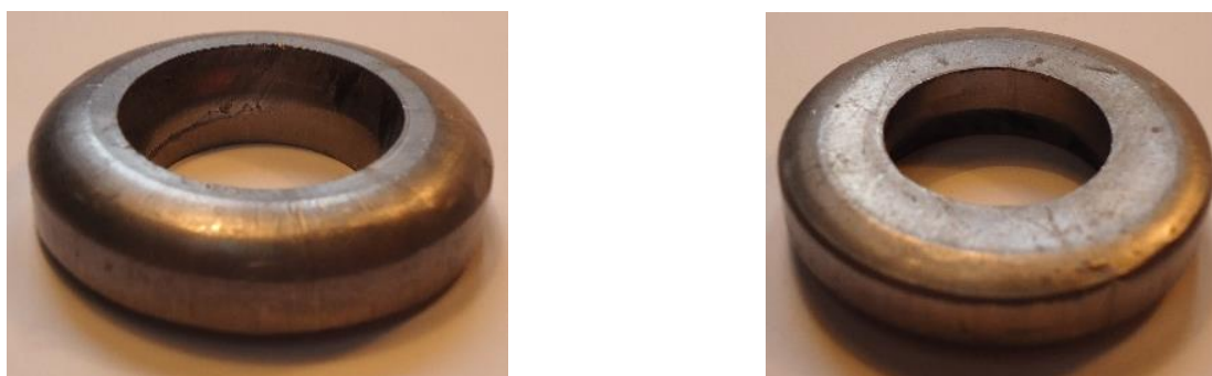
Рис. 5.30. Детали типа колец, полученные при радиальном выдавливании с внедрением пуансона в тело фланца
