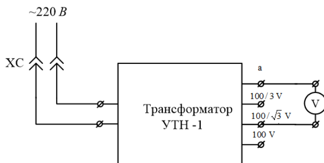
Рисунок 1.2 – Схема електрична принципова приєднання вольтметра для вимірювання середньої за величиною напруги
