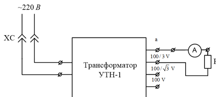
Рисунок 2.3 – Схема електрична принципова приєднання амперметра для вимірювання найменшої за величиною сили струму від трансформатора
