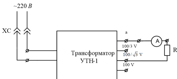
Рисунок 2.2 – Схема електрична принципова приєднання амперметра для вимірювання середньої за величиною сили струму від трансформатора
