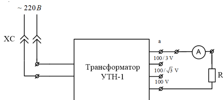
Рисунок 2.1 – Схема електрична принципова включення амперметра для вимірювання max сили струму від трансформатора
