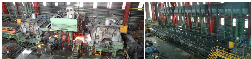
Рисунок 1.18 – Зовнішній вигляд дільниці стану Стеккеля (ліворуч) та установки прискореного охолодження (праворуч)
