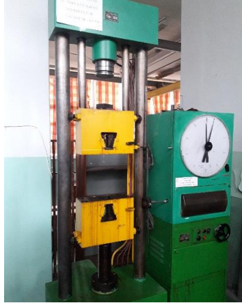
Рисунок 2.1 – Зовнішній вигляд гідравлічної універсальної випробувальної машини моделі Р-20
