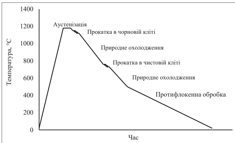
Рисунок 6.26 – Схема термомеханічного процесу прокатки товстих листів зі сталі марки ЕН36 на стані 3600
