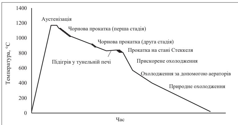
Рисунок 6.12 – Схема термомеханічного процесу прокатки сталі категорії міцності Х65 на стані Стеккеля
