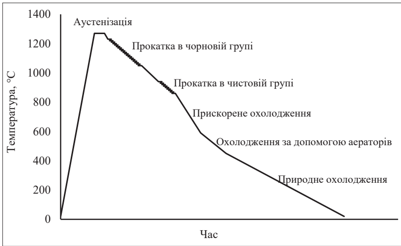
Рисунок 6.19 – Схема термохімічного процесу прокатки рулонів зі сталі марки В на стані 1700
