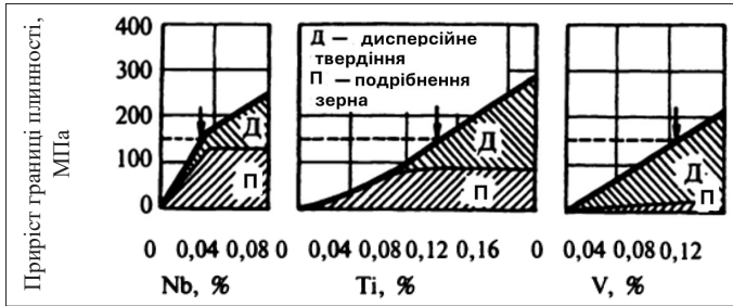
Рисунок 1.22 – Співвідношення ефектів подрібнення зерна та дисперсійного твердіння при мікролегуванні сталі Nb, V та Ti [200]
