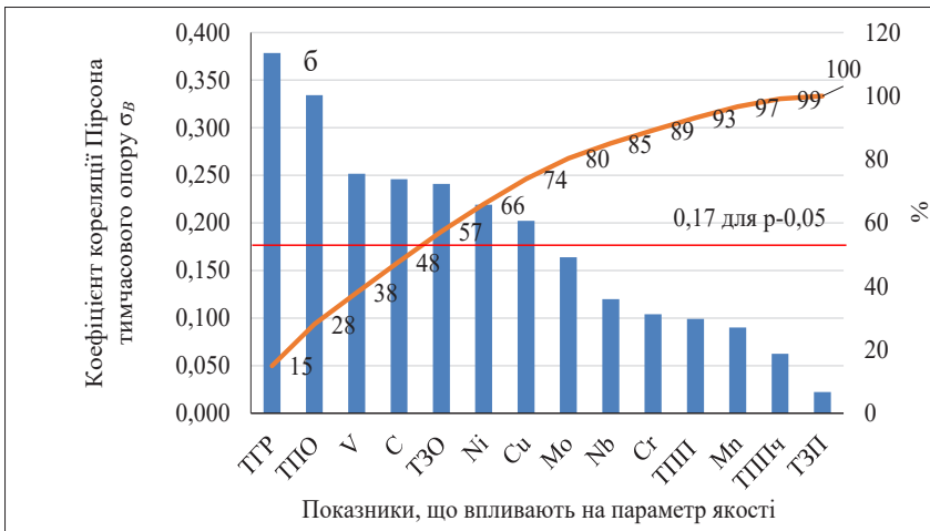
Рисунок 7.8 – Діаграма розподілу вірогідності апроксимації (а) та коефіцієнта кореляції Пірсона (б) по показниках, які впливають на тимчасовий опір прокату зі сталі марки К60
