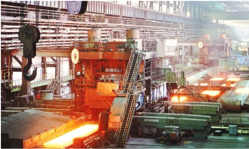
Рисунок 1.8 – Зовнішній вигляд ділянки робочих клітей стану 3000 з зображенням чорнової кліті, байпасу та чистової кліті
