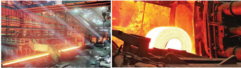
Рисунок 1.16 – Зовнішній вигляд деяких клітей чорнової групи (ліворуч) та установки CoiIBox (праворуч) стану 1680
