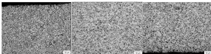
Рисунок 6.20 – Мікроструктура поперечних зразків від рулонів товщиною 4,7 мм, плавки 162955-3 після травлення, \times 200
