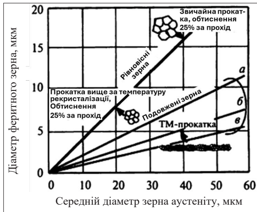
Рисунок 1.21 – Співвідношення між діаметром феритного та аустенітного зерен у залежності від технології прокатки: а – двократна товщина; б – трикратна товщина; в – чотирикратна товщина чистового підкату при деформації нижче температури рекристалізації аустеніту [200]
