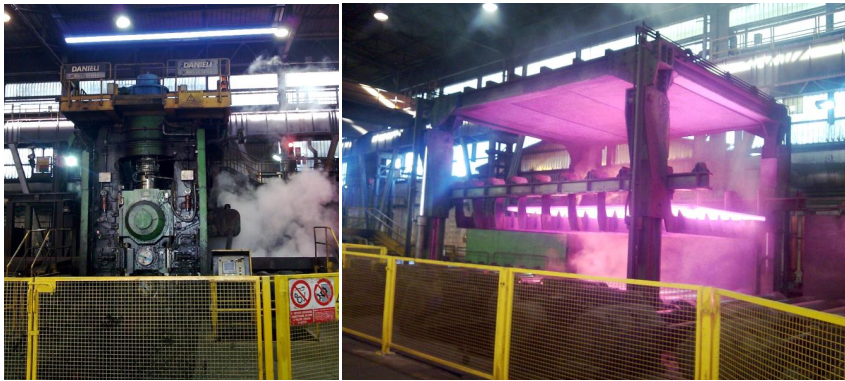
Рисунок 1.12 – Зовнішній вигляд робочої кліти стану 3200 (ліворуч) та підйомного пристрою для охолодження прокату перед чистовою прокаткою (праворуч)
