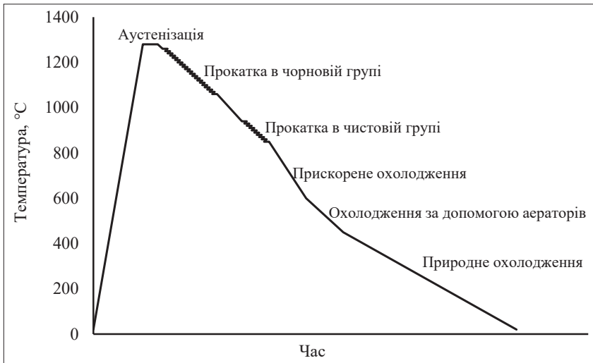
Рисунок 6.22 – Схема термомеханічного процесу прокатки рулонів зі сталі категорії міцності X52 на стані 1700
