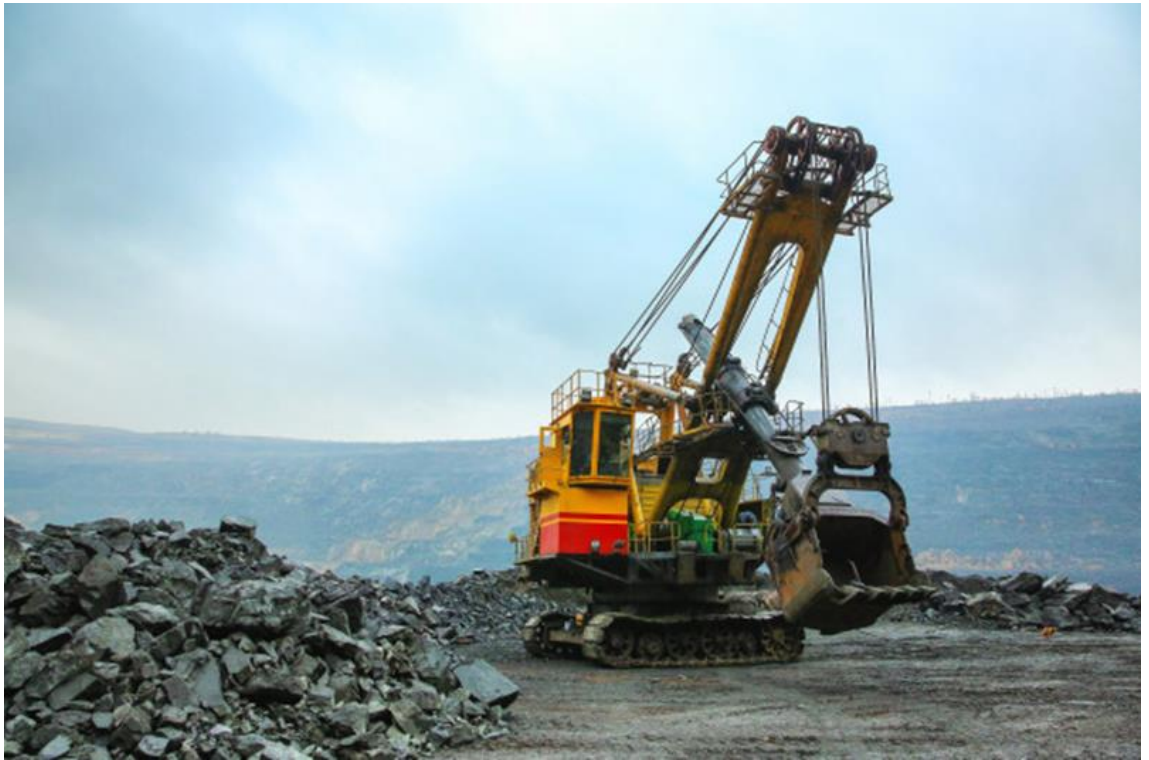
Рисунок 3.3. Екскаватор ЕКГ-12 після ремонту
