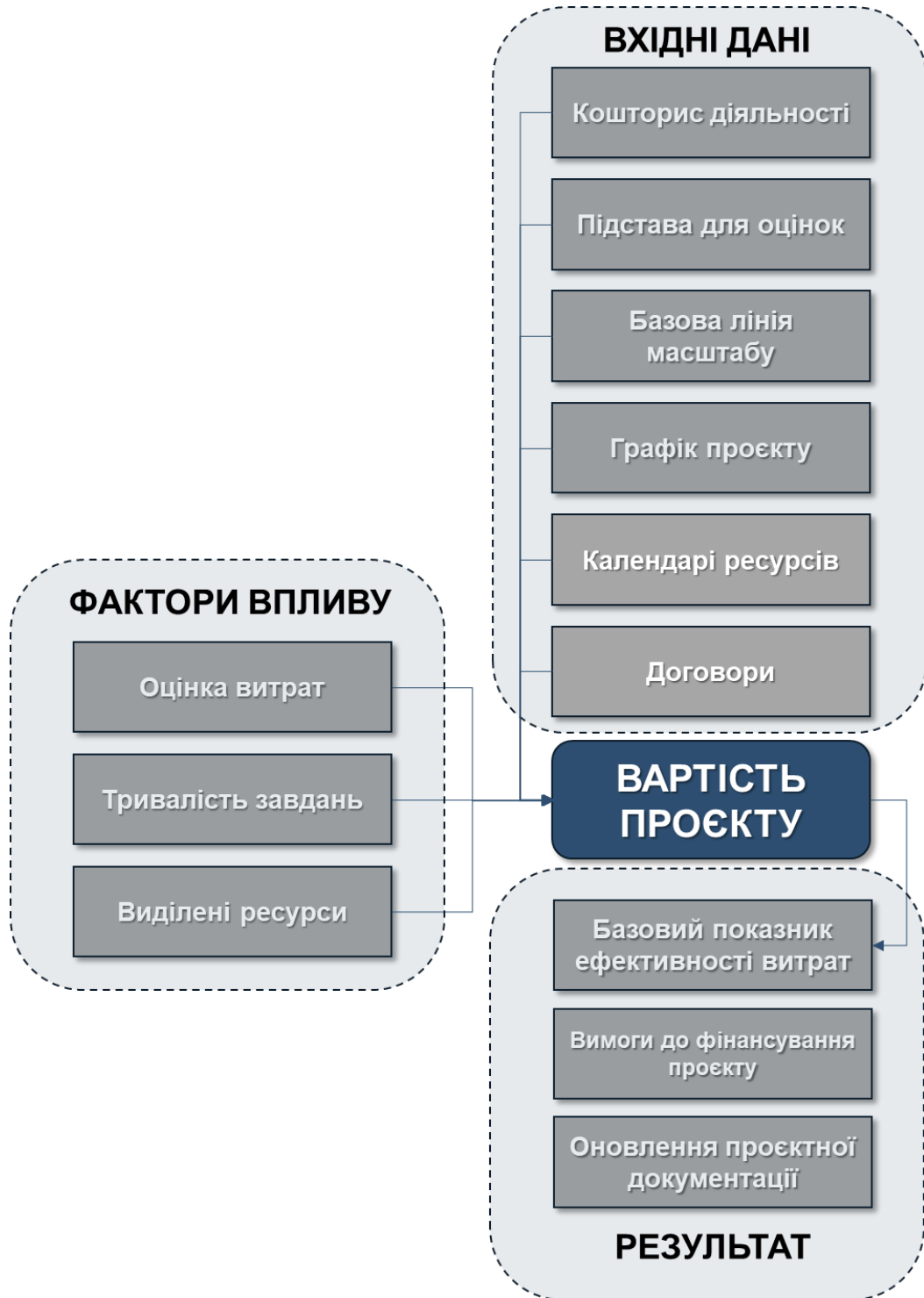
Рисунок 17 – Формування вартості проєкту: фактори впливу, вхідні дані та результат (угруповано на підставі матеріалів)
