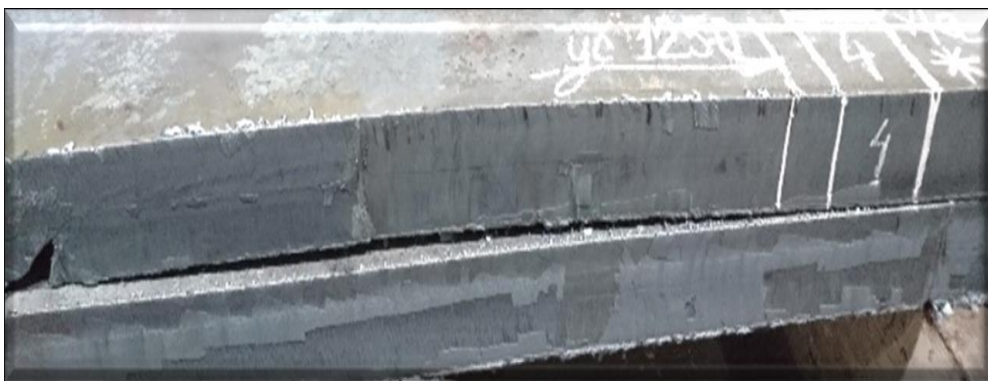
Мал. 4.3 Зовнішній вигляд осьової частини сляба після розпуску із застосуванням теплоізолюючої суміші «СК-В4-У1»
