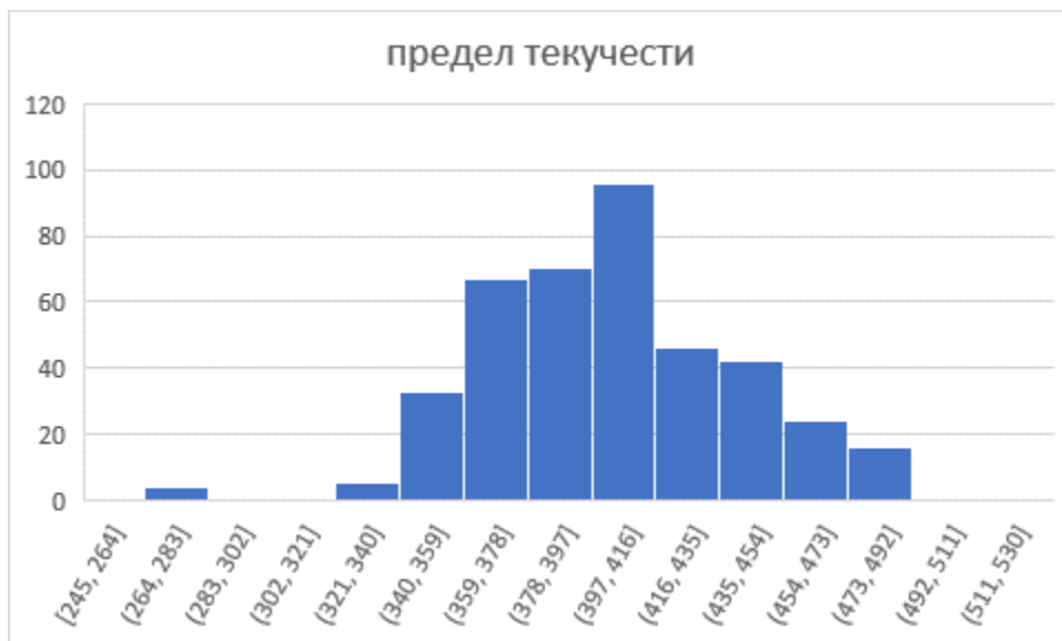
Мал. 2.3 Дані межі плинності сталі марок S235JR, S275JR, S355JR, отримані на базі досліджень у замовника ФЕРРЕРА Італія.
