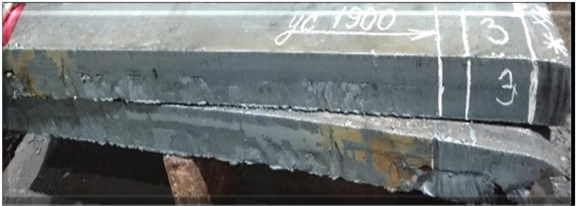
Мал.4.4 Зовнішній вигляд осьової частини сляба після розпуску із застосуванням теплоізолюючої суміші «СП2(К)»
