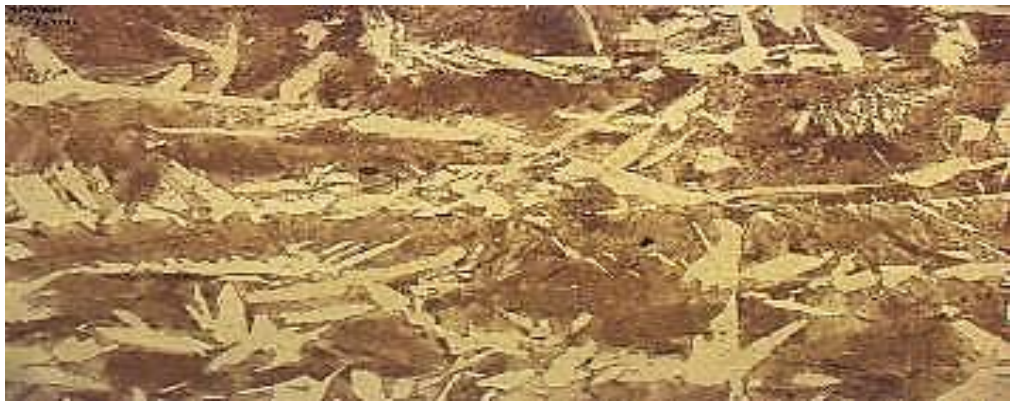
Мал. 3.3 Мікроструктура зразка товарного сляба після травлення
