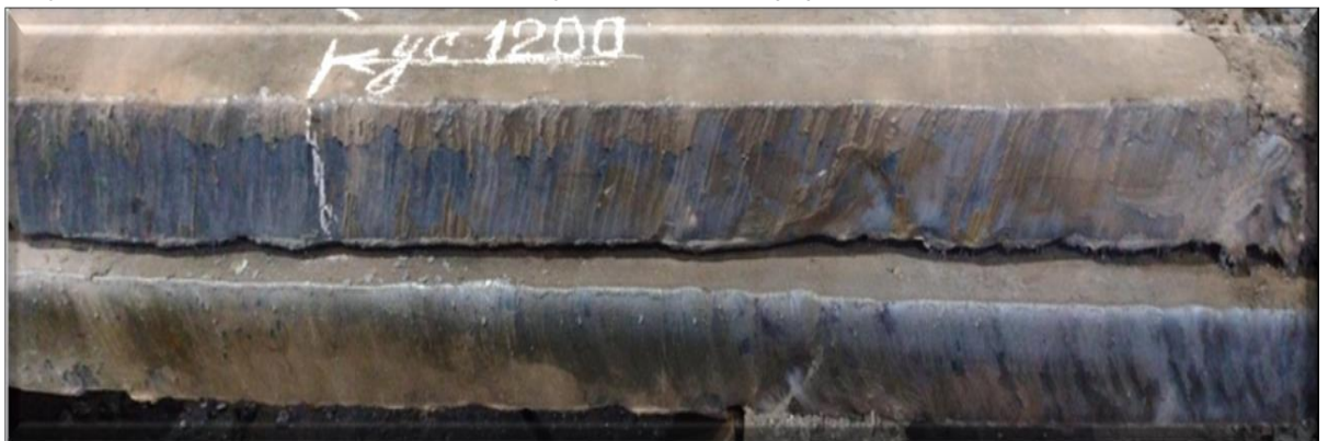
Мал. 4.5 Зовнішній вигляд осьової частини сляба після розпуску із застосуванням теплоізолюючої суміші «ПГС-1»
