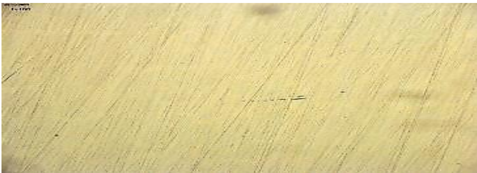
Мал. 4.7 Мікроструктура товарного слябу після впровадження рекомендованих заходів
