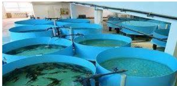
Рис. 8.1. Різні форми рибоводних басейнів, що використовуються в УЗВ
