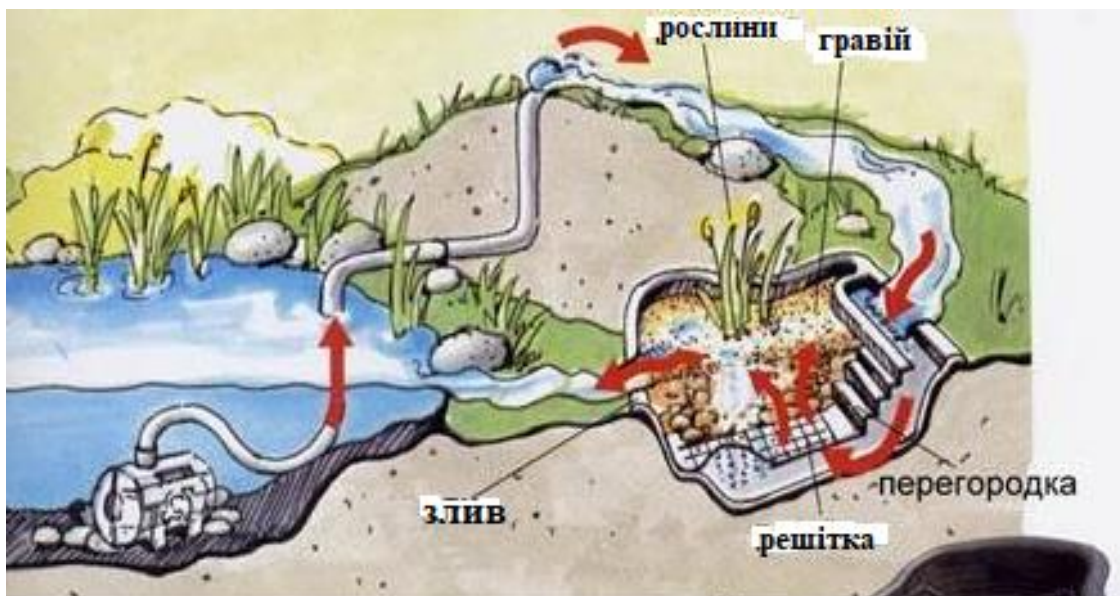
Рис. 10.1. Схема біоплато для очищення води у ставку.
