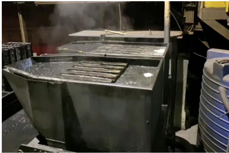
Рисунок 1.9 – Накопичення бруду на поверхні емульсії в коробі зі встановленими пластинами
