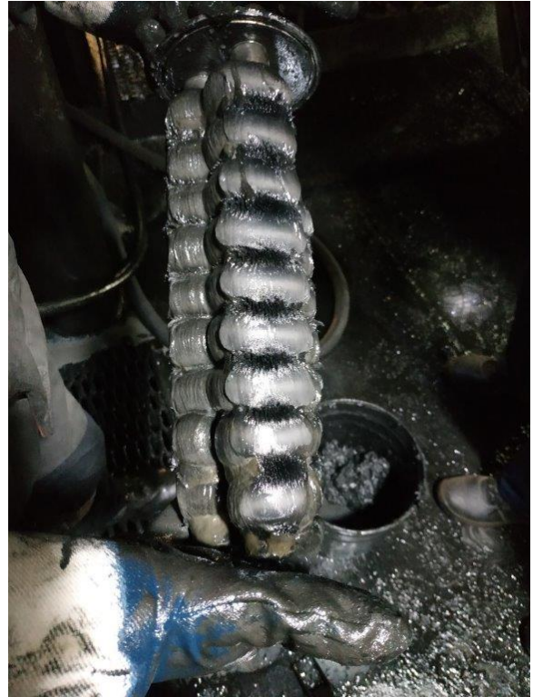
Рисунок 1.11 – Очищення магнітного фільтра від налиплого бруду
