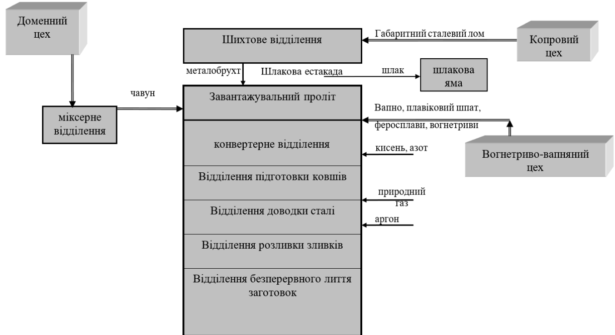
Рисунок 1.1 - Структурна схема конвертерного цеху
