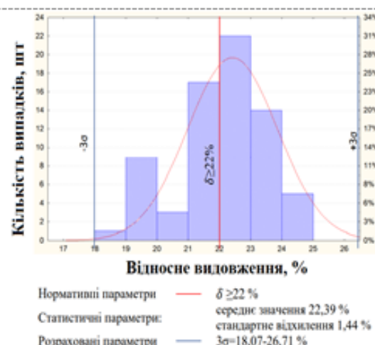
Рис. 11. Розподіл відносного видовження прокату товщиною 14 мм зі сталі марки К60
