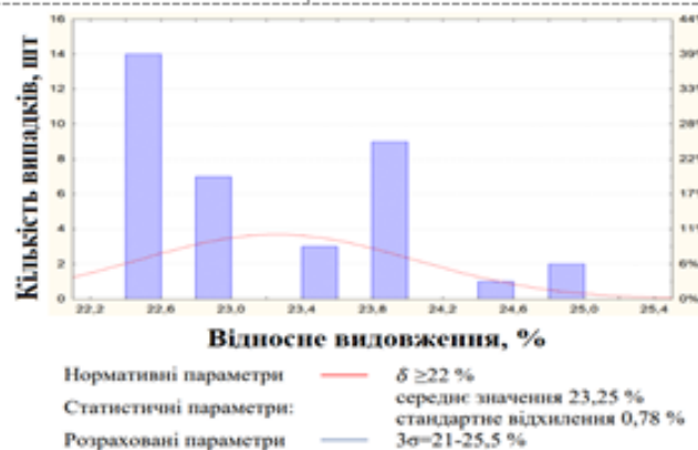
Рис. 14. Розподіл тимчасового опору прокату товщиною 14 мм зі сталі марки K60, зелений рівень процесу
