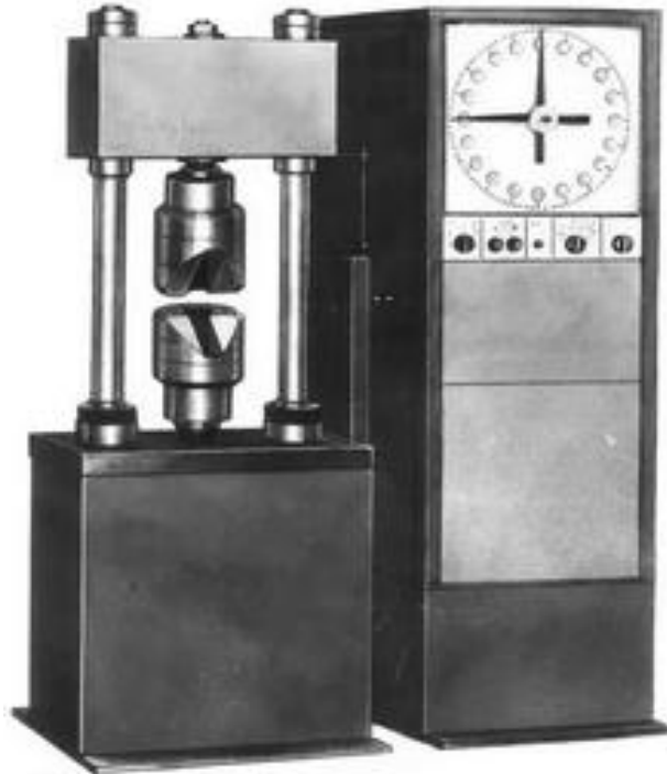
Рисунок 1.1 – Гідравлічна розривна машина МР-200
