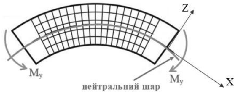
Рисунок 3.2 – Деформація при чистому згині
