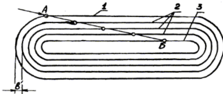
Рис.6 – Траса простої форми АВ; А, В – початок та кінець траси відповідно; 1,3 – верхній та нижній контури кар'єру відповідно; 2 – верхні бровки уступів; b' – відстань між горизонталями.
