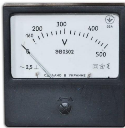
Рисунок 4.5 - Приклад зовнішнього виду вольтметр електромагнітної системи
