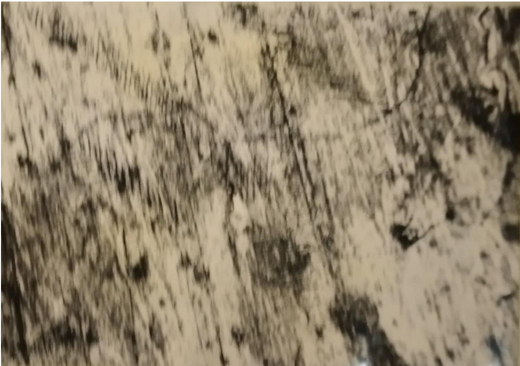
Рис.16.- Типова мікроструктура сталі 120Г18Х2МНЛ \times 70 .
