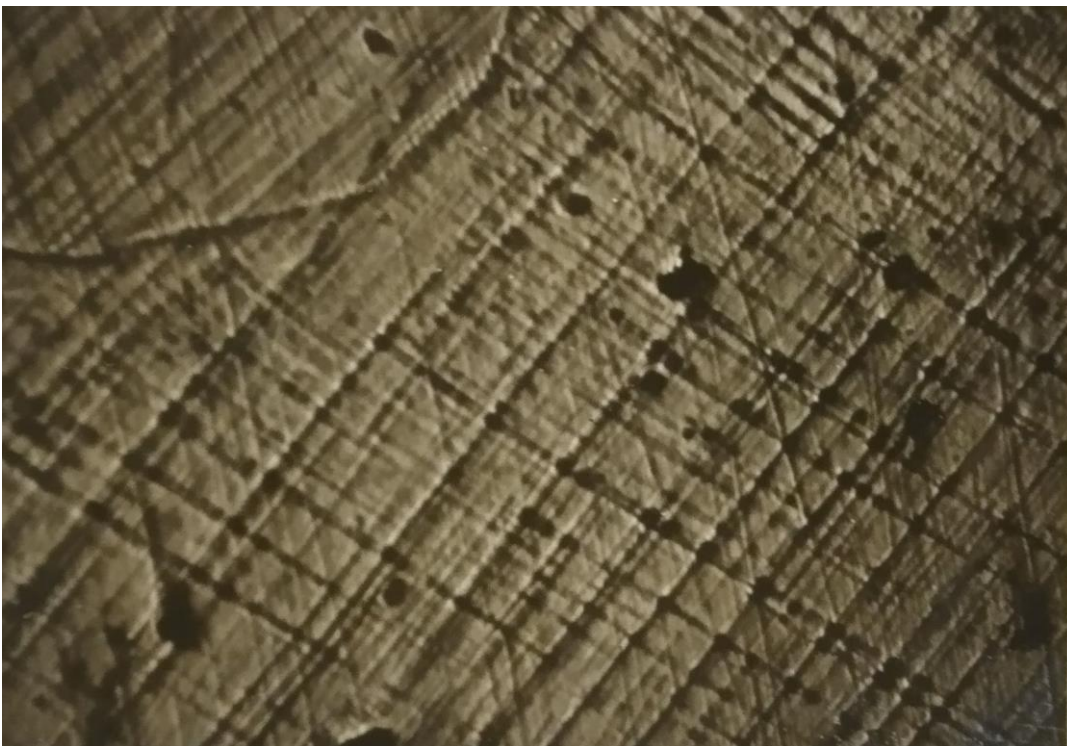
Рис.18.-Типова мікроструктура наклепаного шару сталі 120Г18Х2МНЛ ×70
