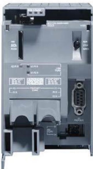
Рисунок 1.3 – З'єднання шини та елементи керування під передньою кришкою CPU 1516-3PN/DP
