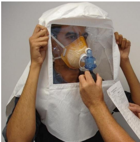
Рисунок 3.9 – Метод перевірки щільності прилягання фільтрувальних півмасок одним з якісних способів
