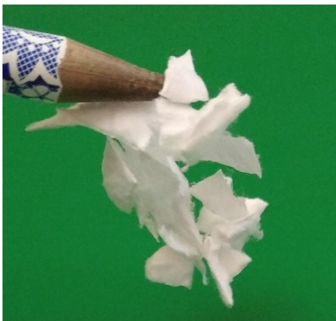
Рисунок 2.11 – Наявність електростатичного заряду проявляється в притягуванні частинок
