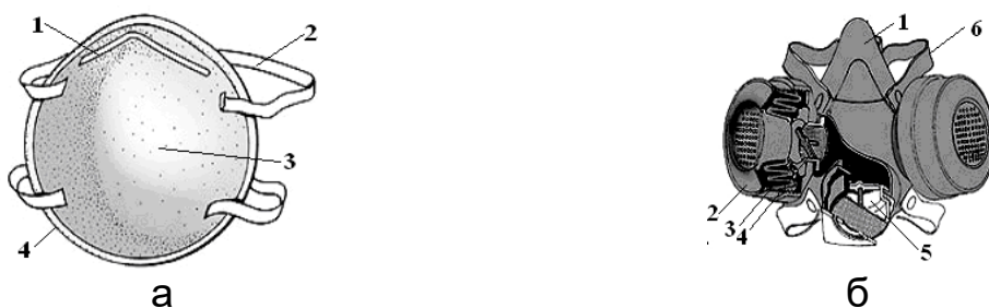
Рисунок 3.4 – Типи фільтрувальних ЗІЗОД[6]: з фільтрувальною частиною (а): 1 – носовий затискач; 2 – наголів'я; 3 – фільтрувальна півмаска; 4 – обтюратор; з еластомерною півмаскою (б): 1 – півмаска з еластичного матеріалу; 2 – фільтрувальна коробка; 3 – фільтр; 4 – клапан вдиху; 5 – клапан видиху; 6 – наголів'я
