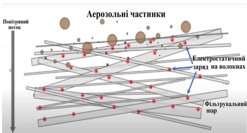
Рисунок 2.10 – Візуалізація уловлювання аерозольних частинок фільтрувальним шаром з електростатичним зарядом
