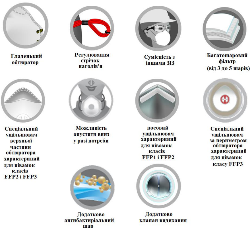
Рисунок 2.4 – Конструктивні елементи фільтрувальних півмасок на які слід звернути увагу
