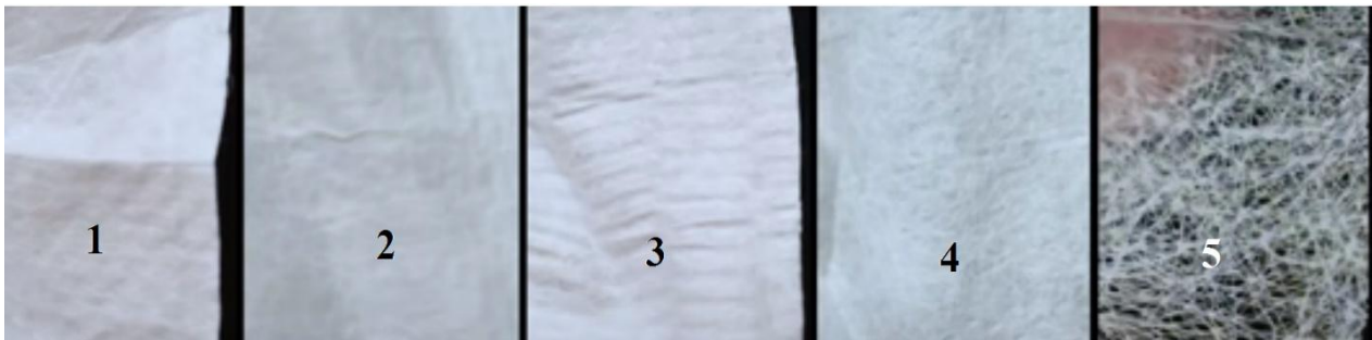
Рисунок 2.13 – Порівняння фільтрувальних матеріалів за щільністю упаковки волокон
