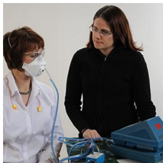
Рисунок 2.2 – Вхідний контроль респіраторів за допомогою PortaCount Plus
