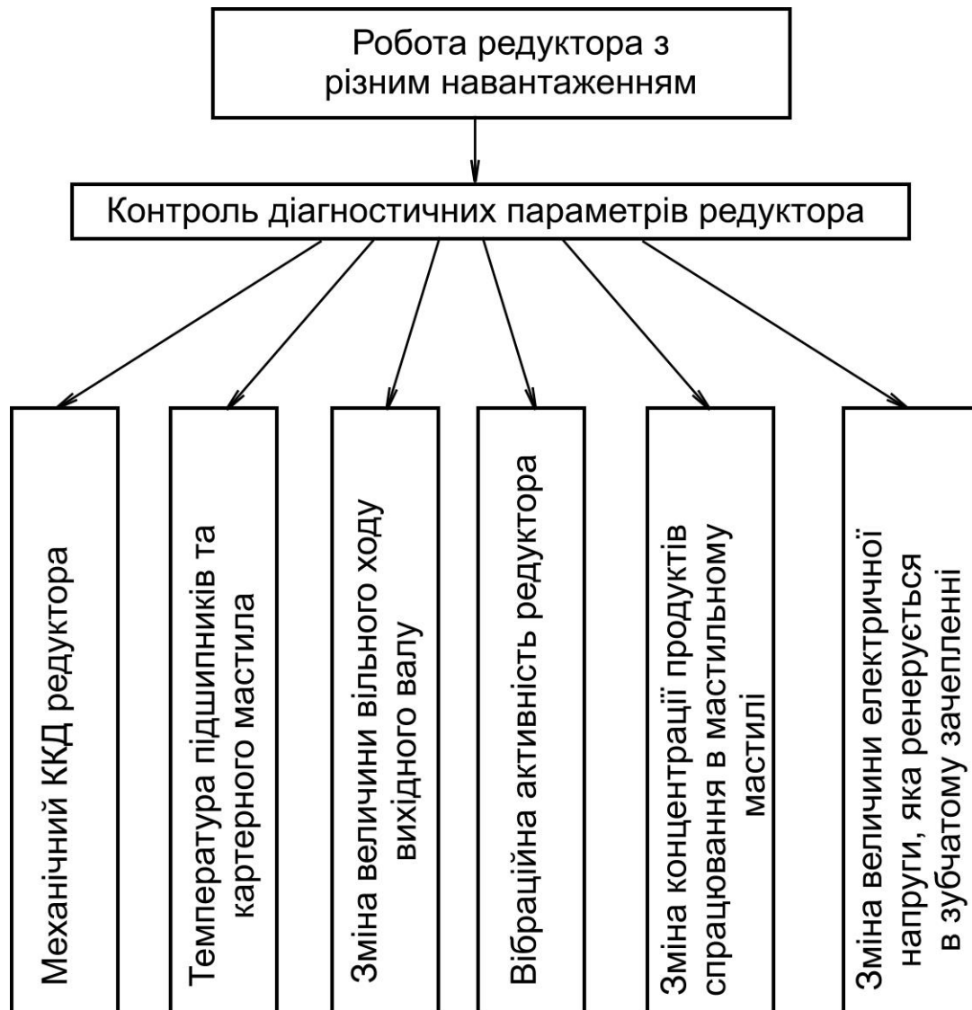
Рисунок 5.3 – Послідовність визначення контролепридатності діагностичних параметрів редуктора
