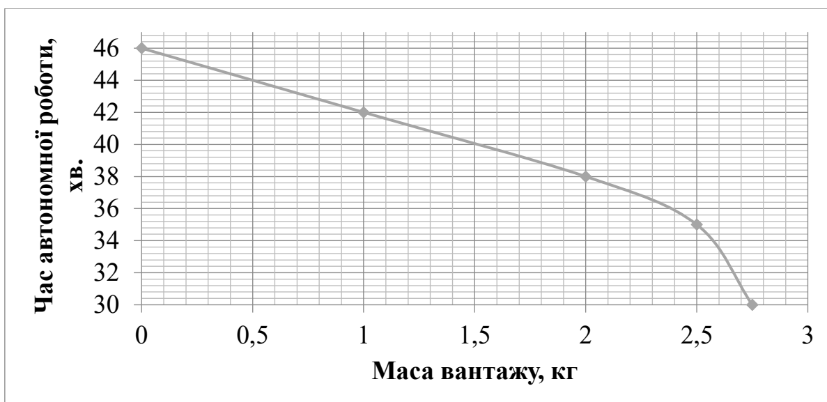
Рисунок 8.3 – Графік залежності часу транспортування та маси вантажу
